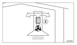
Bei Umluftbetrieb wird der Schalldämpfer zwischen Ausblasstutzen und Umlenkweiche positioniert ②. Prüfen Sie den Einbauraum.
