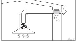
Bei Abluftbetrieb dämpft der Schalldämpfer sowohl Gebläsegeräusche nach außen als auch Außengeräusche, die über die Abluftleitung in die Küche dringen (z. B. Straßenlärm). Dazu wird der Schalldämpfer möglichst nah vor dem Abluftaustritt ① positioniert.
