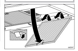
■ Die Verriegelung des Fettfilters öffnen, den Fettfilter ca. 45° nach unten schwenken, aushaken und herausnehmen.
