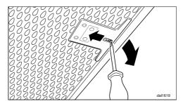
Sollten die Fettfilter einmal verkehrt eingesetzt worden sein, können Sie die Verriegelung durch die Aussparungen mit einem kleinen Schraubendreher entriegeln.
