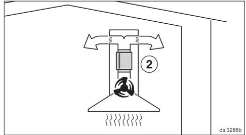
Bei Umluftbetrieb wird der Schalldämpfer zwischen Ausblasstutzen und Umlenkweiche positioniert ②. Prüfen Sie den Einbauraum.
